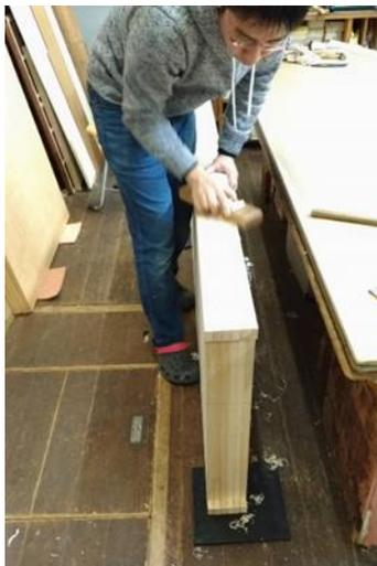
下地が十分に乾燥したら、釘でひっつけて通りをついて本体寸法を整える。
